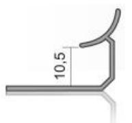
**ÍK10** 10mm Perfil interno de acabamento em cerâmica
