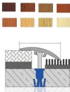
**CGP30** Perfis de transição com padrão de madeira com canal oculto montado por parafuso
