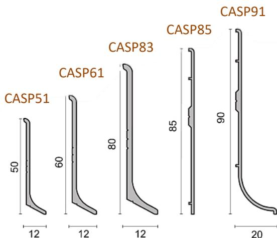
Rodapés de alumínio adesivo ou parafusado com alturas de 50,60,80,85,90mm.
