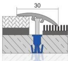
**CGP30** Perfis de transição com canal oculto montado por parafuso
