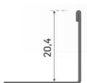
**CSB08-20** 20mm Perfil de acabamento de cerâmica em aço inoxidável
