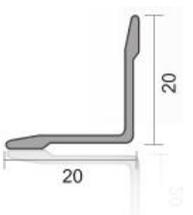
**ÍK20** 20mm Perfil interno de acabamento em cerâmica
