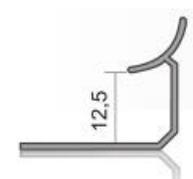
**ÍK12** 12mm Perfil interno de acabamento em cerâmica
