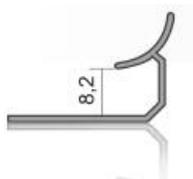
**ÍK08** 8mm Perfil interno de acabamento em cerâmica
