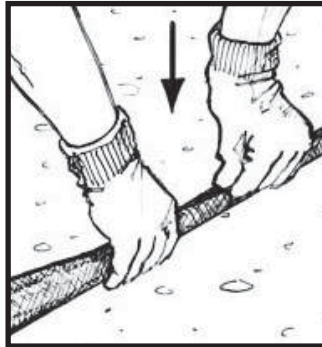
Antes de a cola secar, introduzir o cordão VEDAFEU C em força
