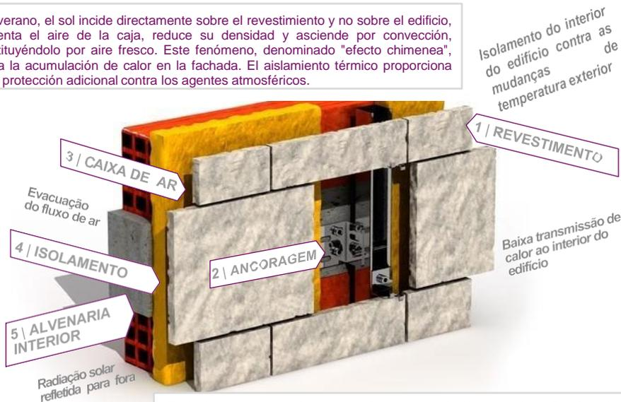
En invierno entran en juego otros factores, motivado a que la radiación solar no es suficiente para garantizar el movimiento del aire por diferencial térmico. En este caso, la fachada actúa como un acumulador de calor, ayudando a la caja de aire en la estabilidad térmica del sistema. El aislamiento térmico evita la pérdida de calor del edificio.
