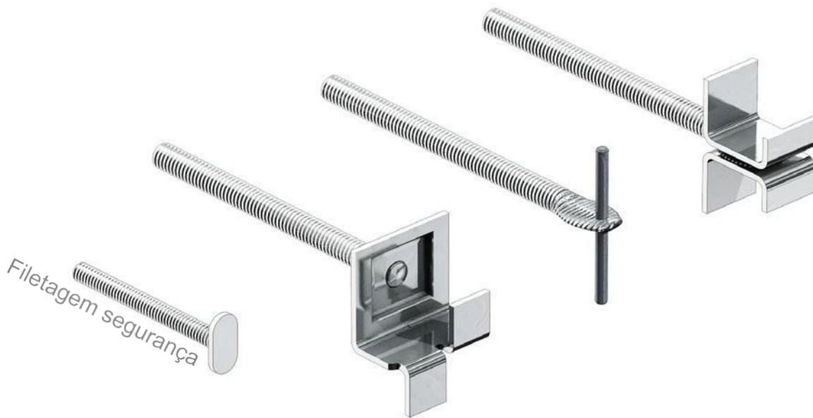
Anclaje fija no ajustable, de gran simplicidad, resistencia y economía. Consiste en dos partes: la grapa que soporta el revestimiento y la varilla o tornillo embutido en la pared.
