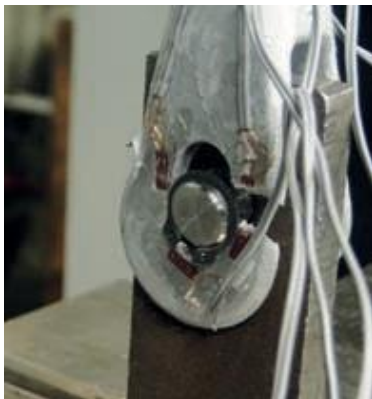
Ensayos de tracción en una horquilla M16 con una carga de rotura de 150 kN. Fig. TU Munich
