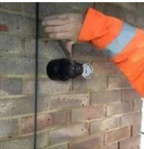
**Los anclajes STATI-Dry deben ser probados en la resistencia a la tracción.**
