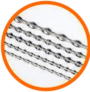
El varilla de anclaje STATI-Bar en acero inoxidable se suministra en longitudes hasta 10,00m, se pueden introducir por separado o varias varillas en un mismo surco. Este método de aplicación permite crear lentes de refuerzo sin ningún cambio de la estereotomía de la pared. Varones individuales con 1,00m, se insertan en surcos transversales a las fisuras aisladas existentes para las grapas.
