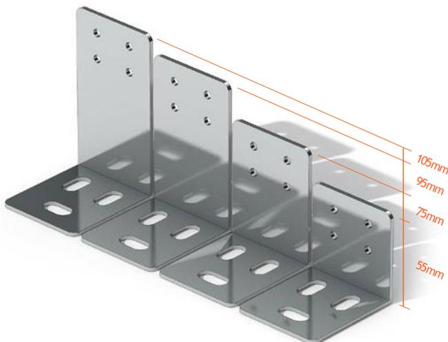
Cuando se usan como escuadras de carga transmiten las cargas verticales del cerramiento directamente a los forjados, fijándose mediante taco mecánico. En su uso como apoyos intermedios evitan la flexión del perfil por efecto del viento, y se fijan mediante tornillo tirafondo con taco de nylon y/o mediante un anclaje químico.
