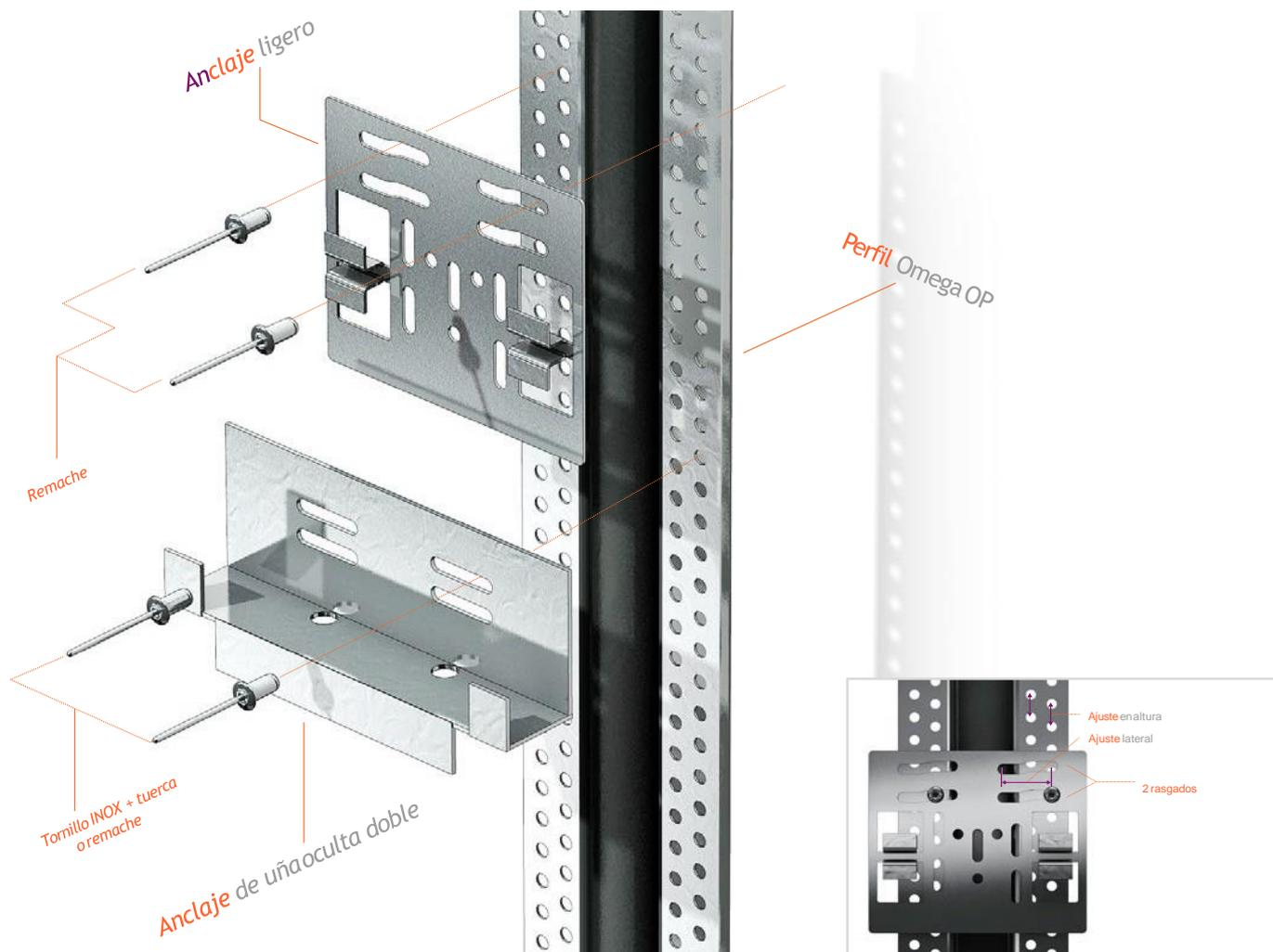
Nuevo sistema de perfiles verticales punzonados tipo Omega. En nuestra fábrica y mediante un proceso industrial, se mecanizan las alas del perfil Omega OP.
