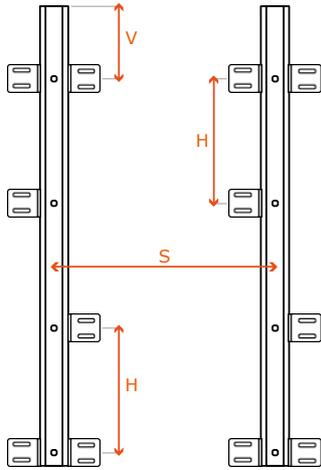
Tabla para determinar la distancia máxima entre soportes o escuadras de nivelación en función de la distancia entre los perfiles verticales
