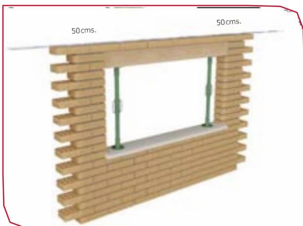
Em seguida, coloque o reforço **fisufor**® na primeira fila de tijolos. É absolutamente imperativo que seja instalado com pelo menos 50 cm de reforço que excedam os dois lados da abertura.
