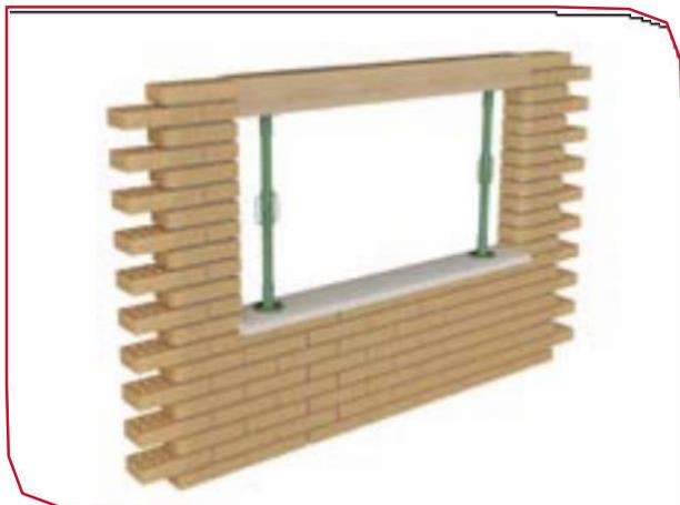
Você deve usar uma viga para garantir a abertura para garantir a estabilidade do edifício.
