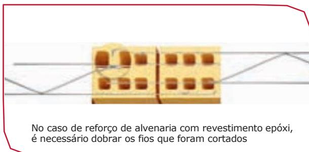
No caso de reforço de alvenaria com revestimento epóxi, é necessário dobrar os fios que foram cortados
