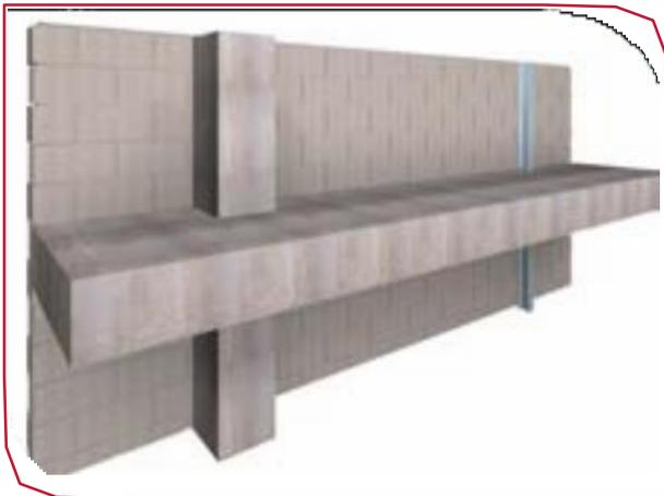
O uso do reforço **fisufor®** em estruturas de blocos de concreto permite a eliminação de aros e armações de metal usando âncoras **geoanc®**, possivelmente eliminando a necessidade total ou parcial de Pilares de apoio vertical (dependendo da situação).
