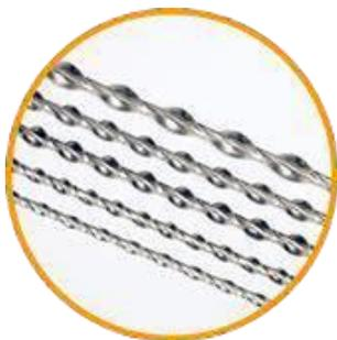
O varão de ancoragem STATI-Bar em aço inoxidável é fornecido em comprimentos até 10,00m, podem ser introduzidos separadamente ou vários varões em um mesmo sulco. Este método de aplicação permite criar lintéis de reforço sem qualquer alteração da estereotomia da parede. Varões individuais com 1,00m, são inseridos em sulcos transversais às fissuras isoladas existentes para as grampear.
