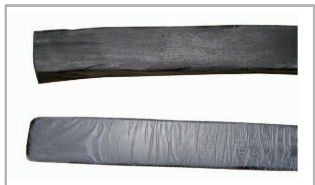
Comparação do aspecto das juntas hidroexpansivas com e sem película de proteção
