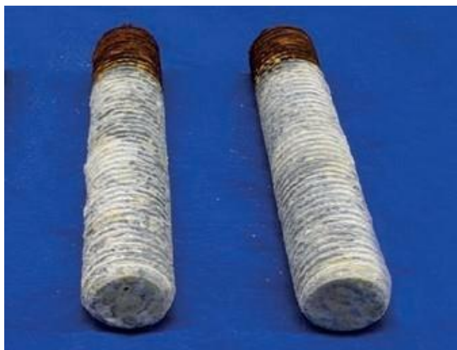
Rosca del extremo de la varilla HMR después de la prueba de niebla salina durante 480 h.
