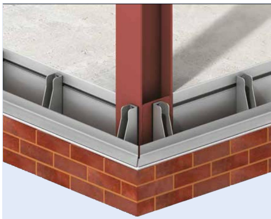
Sistema de suporte MDC aparafusado ao CombiDeck e a uma coluna de canto
