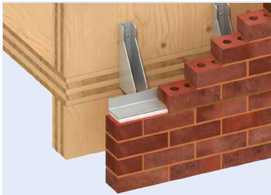
Sistema de suporte de alvenaria Ancon fixado em madeira lamelada cruzada
