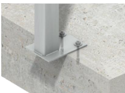
Fixação de uma base de um poste WP3 à superfície de uma laje de betão
