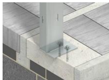
Fixação da base de um poste WP2 a superfície a uma laje aligeirada pre-esforçada
